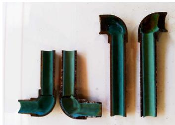
給水管劣化調査（2008年）で抜管サンプル。
