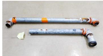
劣化により漏水事故を起こした台所排水枝管のサンプル（2010年頃）
